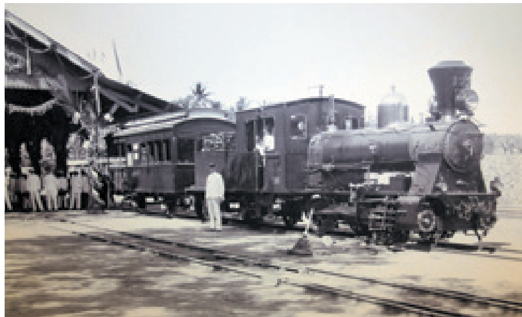
Boven: Deze loc 10? (het laatste cijfer is niet zichtbaar achter het frontsein) van de Samarang Cheribon Stoomtram werd geleverd door de Sächsische Maschinenfabrik vormals Richard Hartmann, Chemnitz, als één van de serie 101-127 (gebouwd 1908-1913). Erachter hangt inspectierijtuig A1 met open balkon. De versiering is waarschijnlijk vanwege de opening van de lijn; rond 1913. Foto: Wangsa Widjaja.
