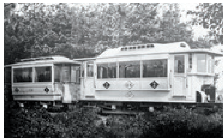
Boven: Trots staat de bestuurder van de Groenlosche Tram met de slinger in zijn hand waarmee hij de motor van 9PK kon aanzwengelen. Duidelijk zijn de beide éénassige rijtuigjes te zien op deze foto uit 1915. De tram had geen wagennummer.
