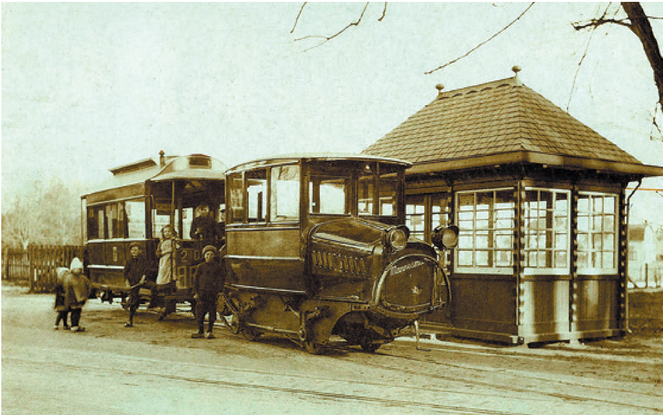
Bij de Gemeentetram Apeldoorn construeerde men in 1919 dit motorlocomotiefje. Motoren en kettingaandrijving zijn afkomstig van Mannesmann 5-tons vrachtwagens uit 1915. Mannesmann Mulag uit Aken (D) had een vertegenwoordiging in Den Haag (Mulag = Motoren und Lastwagen A.G.). Het locje trok meestal slechts één rijtuig, zoals het afgebeelde van Pennock (serie 1-3 uit 1897). Uit deze serie werd zo'n zelfde rijtuig gebruikt voor de bouw van het locje. Er bestaat ook een, helaas slechte, foto waarop het locje drie open rijtuigen sleept. In 1923 werd locje en rijtuigen overgedaan aan de Tramweg Maatschappij de Graafschap. Na een botsing in november 1924 werd ze aan de kant gezet. De locatie is niet erg duidelijk, maar het is waarschijnlijk nabij de remise. Foto: collectie SNR.
