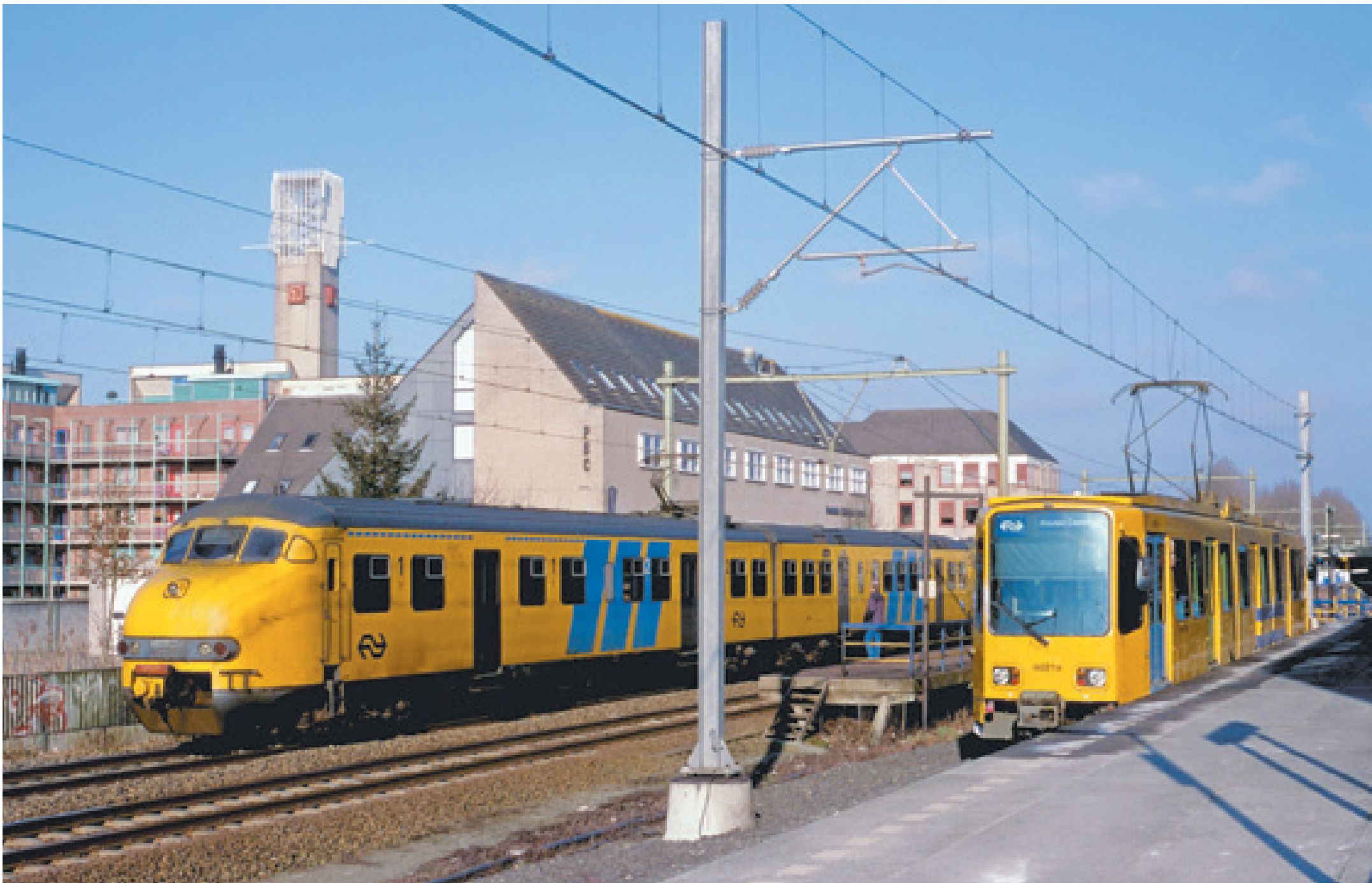
Bij het station van Houten konden treinpassagiers met bestemming de Vinex-wijk Houten Zuid overstappen op een NS-HTM tram. Voor dit nauwelijks twee kilometer lange pendellijntje waren een apart derde spoor en tijdelijke perrons aangelegd bij beginpunt Houten en eindpunt Houten Castellum. Ex-Hannover 6021 (later vervangen door de 6016) staat hier in 2001 nog vrij van graffiti te wachten, terwijl een plan V voorbij komt. Deze korte tramlijn bestond tussen 8 januari 2001 en 14 december 2008. Nadat de spoorverdubbeling op dit traject gereed was gekomen werd in 2010 het nieuwe NS-station Houten Castellum in gebruik genomen. Foto: Tom Tand.
